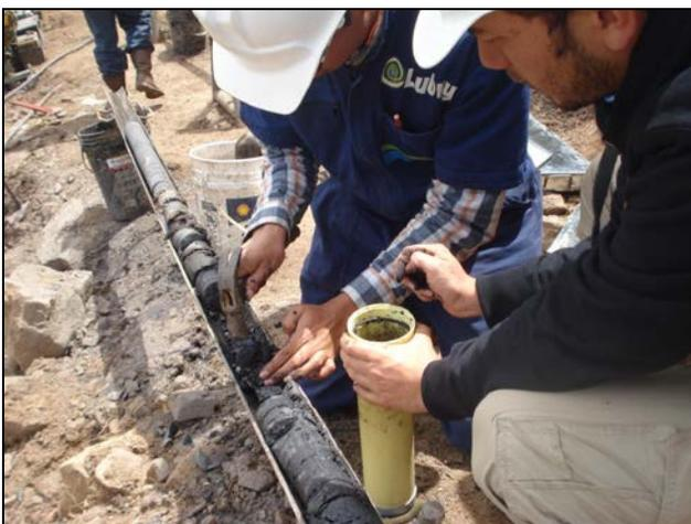
**Figura 12.** Preparación de muestra de carbón para disposición en el canister y posterior medición de contenido de metano. Pozo Socotá-1, Vereda Coscativá, Socotá.
