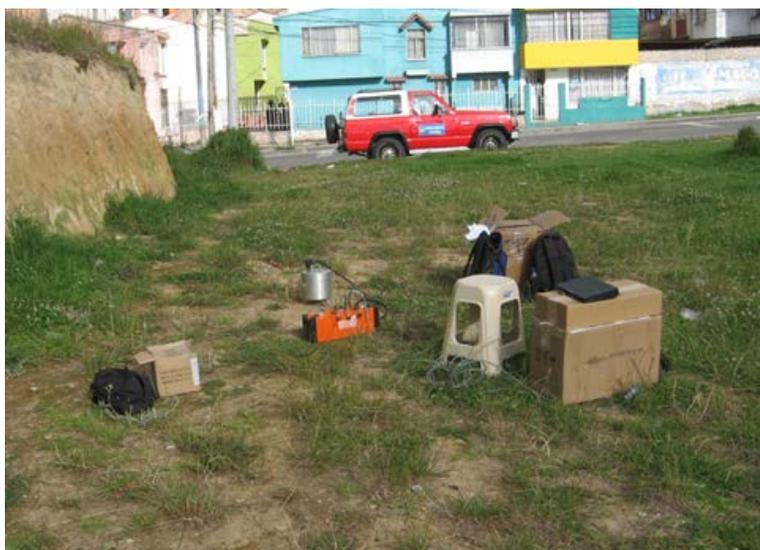
**Figura 28.** Mediciones de microtemblores para determinar el efecto de sitio mediante el método H/V en la ciudad de Pasto.
