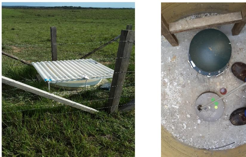
**Figura 16.** Vista externa (izquierda) del bunker de la estación sismológica ubicada en La Macarena, Meta. Ubicación del acelerómetro dentro del bunker (derecha).
