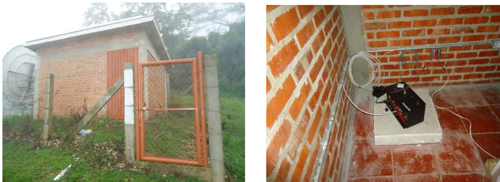
**Figura 15.** Vista externa (izquierda) de la caseta de la estación sismológica ubicada en Ariguní, Magdalena. Ubicación del acelerógrafo en el pedestal dentro de la caseta (derecha).
