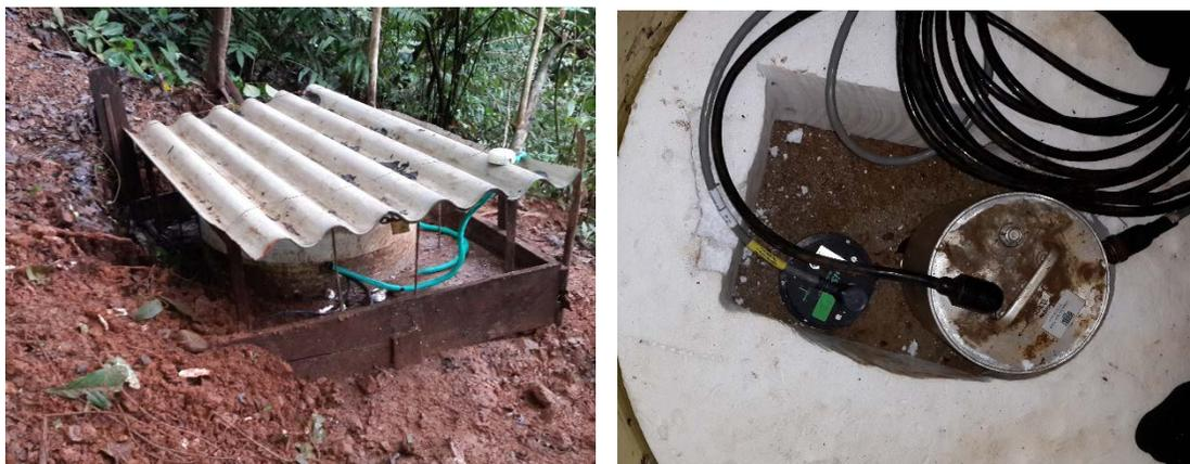
**Figura 17.** Vista externa (izquierda) del bunker de la estación sismológica ubicada en Gorgona, Cauca. Ubicación del acelerómetro dentro del bunker (derecha).
